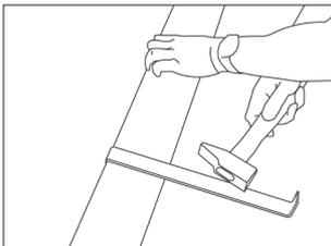
5• Découper les lames de la dernière rangée à la largeur désirée sans oublier l'espace nécessaire au jeu de dilatation. Emboîter les lames à plat avec une chasse métallique. Enlever les cales 24h après la pose. Le recouvrement des joints de dilatation s'effectue à l'aide des accessoires appropriés (plinthes, ronds de radiateur, barre de seuil, etc.).
