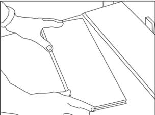
3• Commencer la 2<sup>ème</sup> rangée avec la chute de la dernière lame de la rangée précédente. Veiller à ce que la chute corresponde au moins à deux fois la largeur de la lame pour des raisons esthétiques. Nettoyer aussitôt les traces de colle avec un chiffon ou une éponge légèrement humide.
