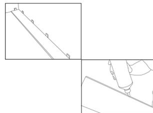
2• Débuter la pose dans un angle, rainure contre le mur. Encoller soigneusement le bord supérieur des languettes sur toute leur longueur avec une colle vinylique aqueuse (ex : Presto BIB). Disposer les cales en périphérie pour respecter le jeu de dilatation.
